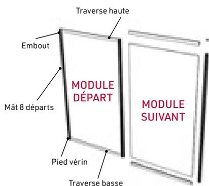
Construction : pour assembler vos panneaux, partir d'un panneau **module départ** composé de 2 mâts puis de panneau **module(s) suivant(s)** composé(s) de 1 mât.
